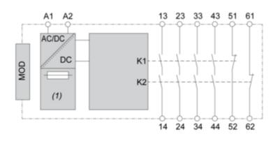
(1) : A1-A2 (Power supply) 13-23-33-43-51-61-14-24-34-44-52-62 : Output MOD : Connector for base safety module
