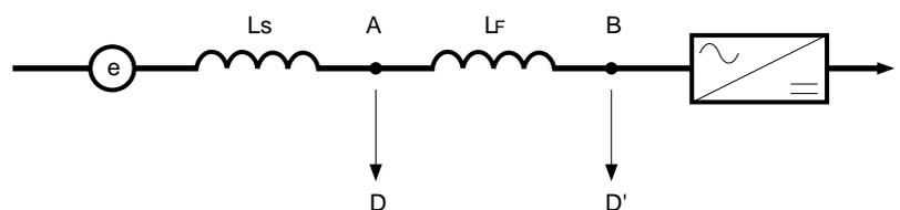
$L_F$ : filtering inductance of rectifier
